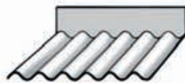
Left apron flashing Raccord de mur gauche
